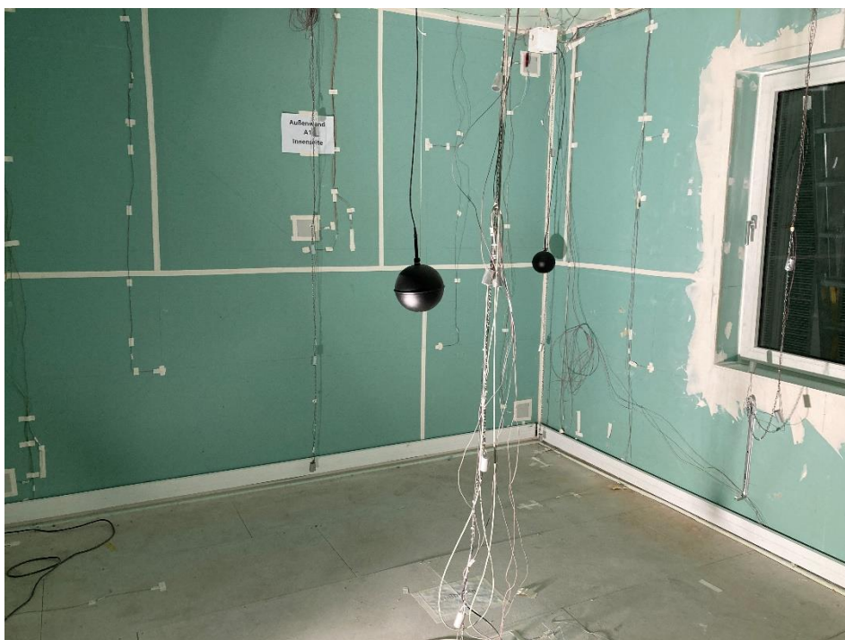
Bild 6: Anordnung der Sockelheizleiste im Messraum.
